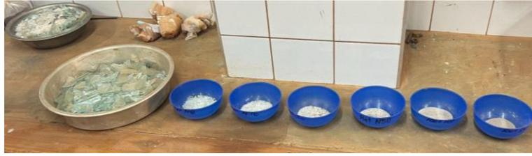
**Fig. N°5. Clasificación del vidrio mediante tamices normalizados.**
