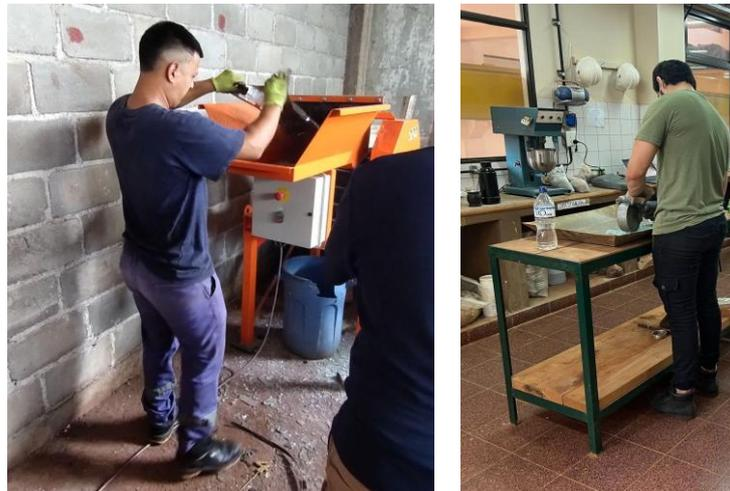
**Fig. N°3. Trituración del vidrio en la planta (izquierda) y en el laboratorio (derecha).**
