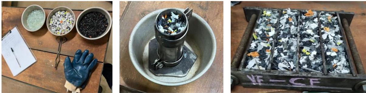
**Fig. N°6. Preparación de una mezcla: vidrio, plástico rígido y flexible.**
