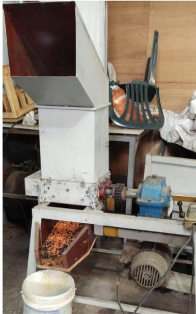
**Fig. N°2. Trituración del plástico.**
