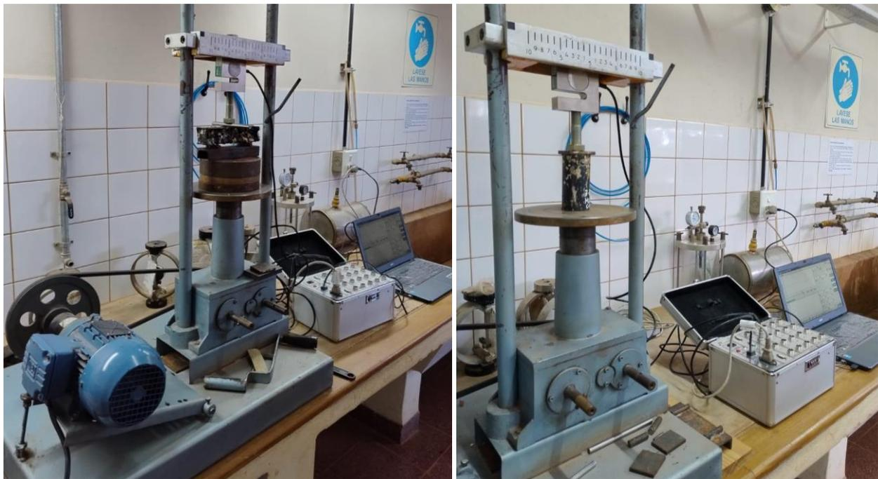
**Fig. N°7. Ensayos a flexión (izquierda) y a compresión (derecha).**
