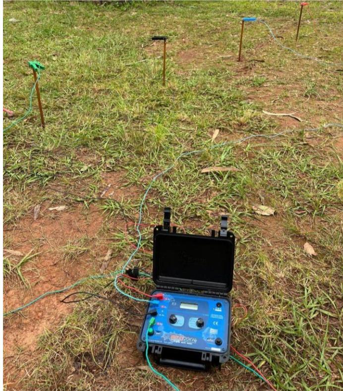
**Fig. 4 - Telurímetro utilizado para la medición de la resistencia del suelo.**
