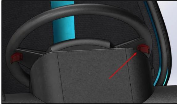
Figura 10 - Palanca de acelerador y freno en el volante.
