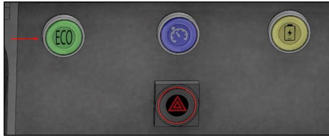
Figura 7 - Interruptores Modo Eco, CC, EE y Balizas.
