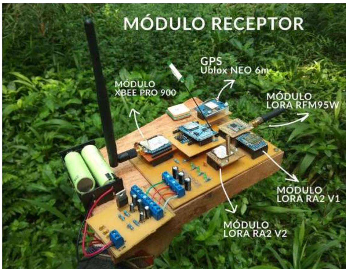
**Fig. 1. Terminal móvil implementado. Fotografía registrada en la RUMG durante los ensayos.**
