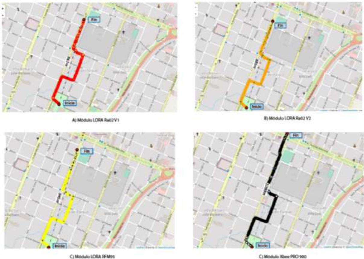
**Fig. 5. Puntos de coordenadas GPS obtenidos durante la prueba de comunicación en ambiente urbano.**
