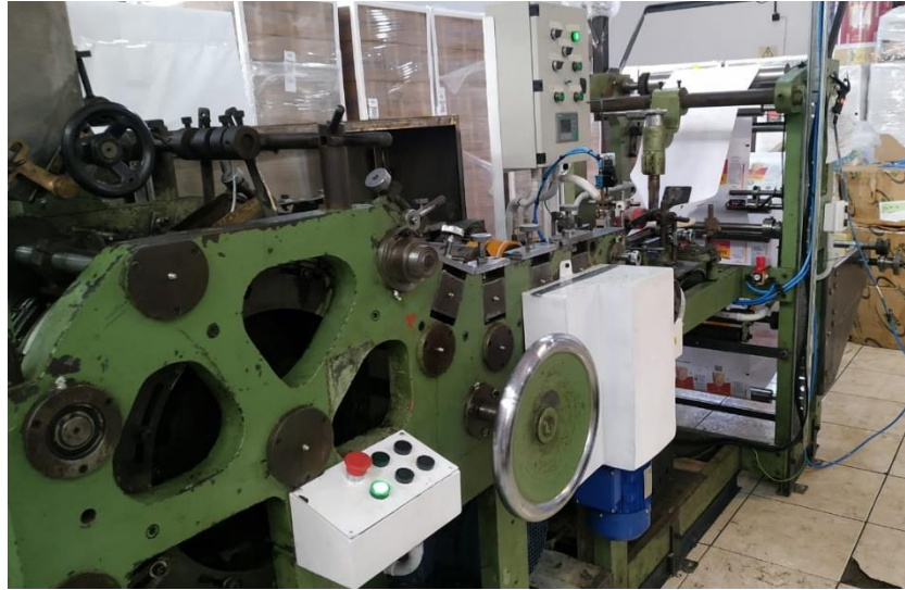
Fig. 1. Vista de confeccionadora acondicionada para envases de harina.
