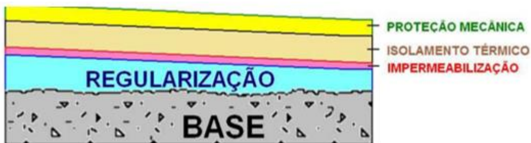
Figura 1. Camadas que compõem um terraço impermeabilizado [9].
