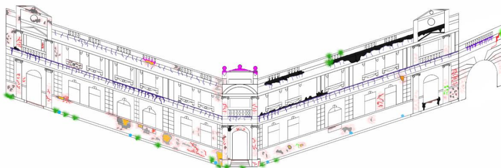
Fig. 2. Fachada Principal e suas lesões em destaque (ALMEIDA (2018))
