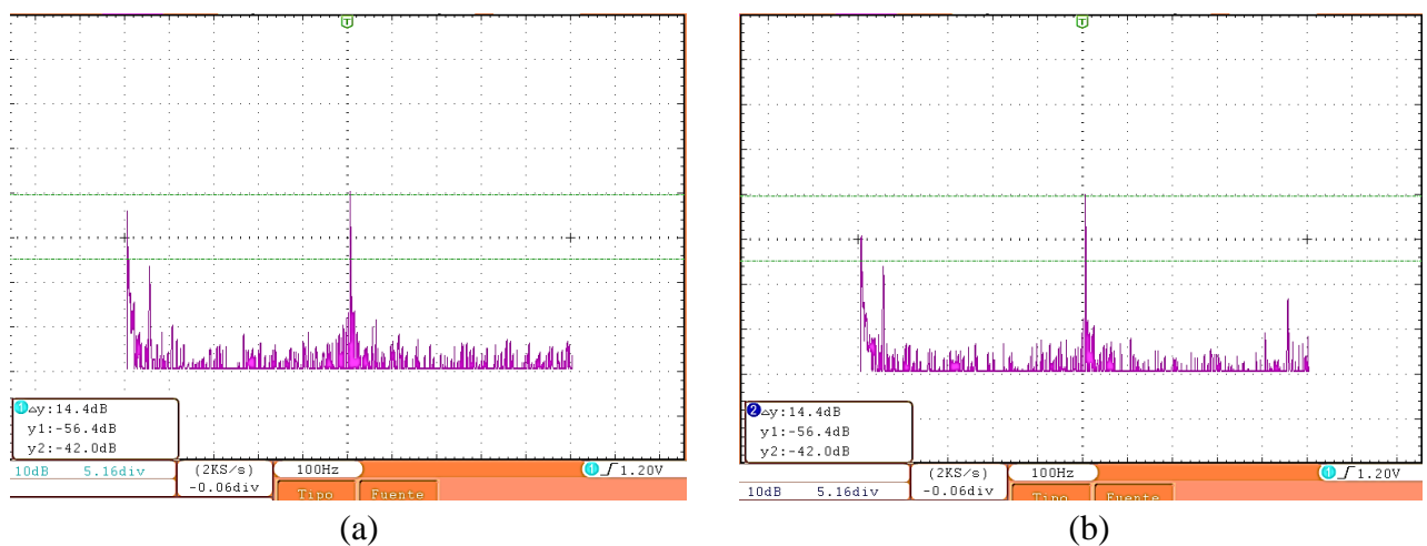
Fig. 7. Simulación de ruido de 50 Hz. (a) Entrada. (b) Salida.
