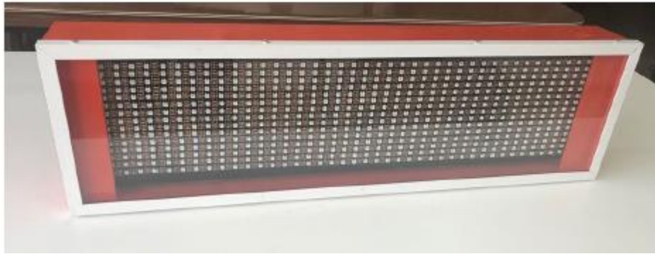
Fig. 4 - Display con matriz de leds inteligentes.
