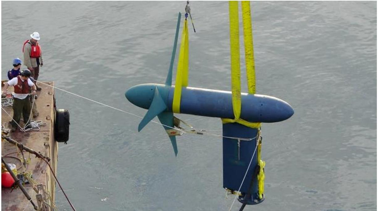
**Fig. 6. Turbina hidrocínética de la empresa Verdant Power, cuarta generación [7].**
