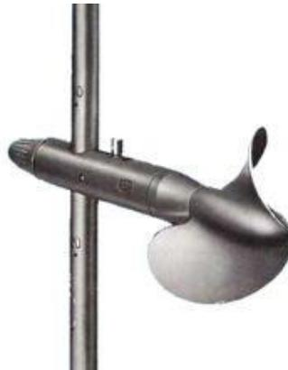
**Fig. 9. Molinete Hidrométrico**
