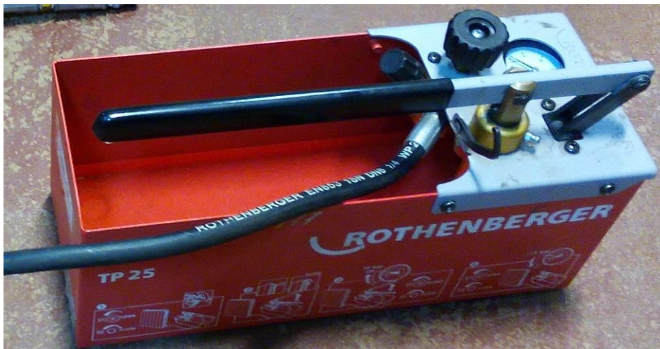
Fig. 8. Máquina para realizar la prueba hidráulica de las probetas
