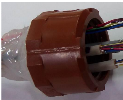
Fig. 4. Cables colocados en el tapón de PVC, antes de ser montados en el tubo metálico
