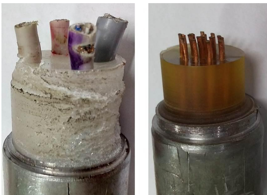
Fig. 10. Probetas después de la prueba de mecanizado (izquierda resina acrílica, derecha Dicure 452)
