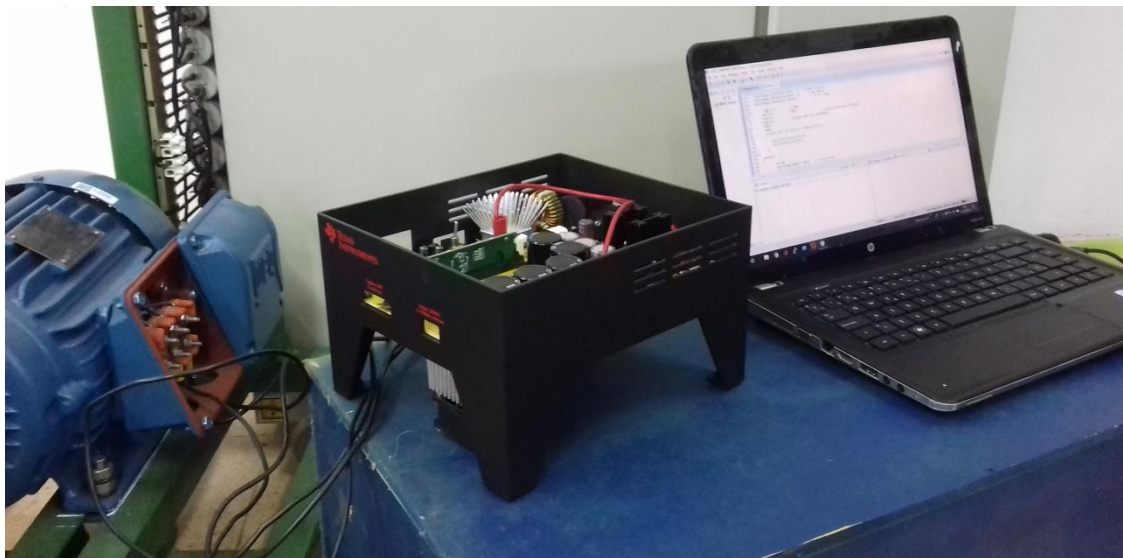
Fig. 2. Prototipo del proyecto. Motor de inducción, inversor trifásico y programador del controlador.
