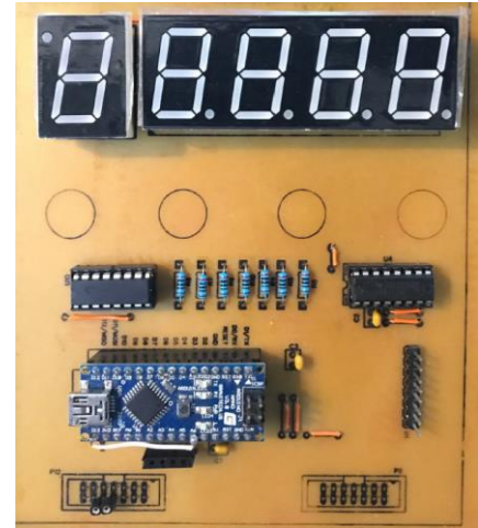
Figura 2. Placa de control del sistema.
