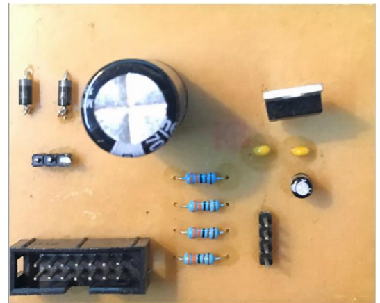
Figura 4. Placa fuente de alimentación para el sistema.
