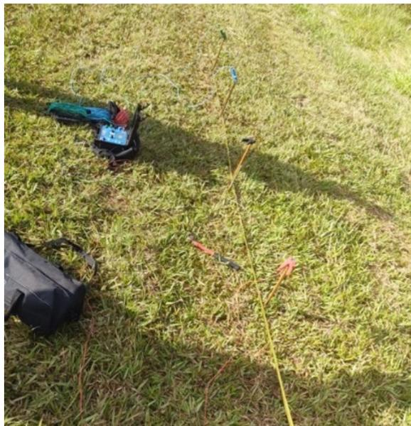
**Fig. 7. Instrumentos de medición utilizados para determinar la resistividad del terreno.**
