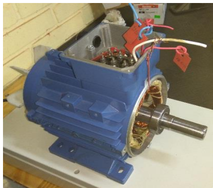
Fig. 3 – Prototipo de MER desarrollada en el laboratorio
