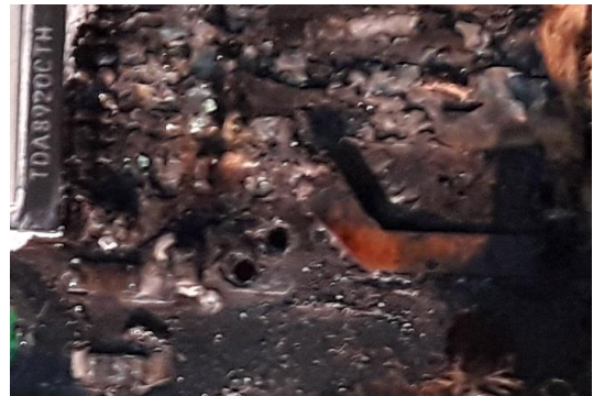
Fig. 6. (b) Corrosión en PCB
