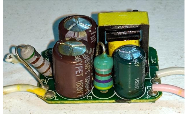
Fig. 2.(b) Corte de seguridad a punto de abrirse
