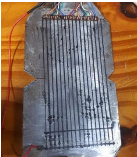
Fig. 10. Soldado de los cables a los terminales.
