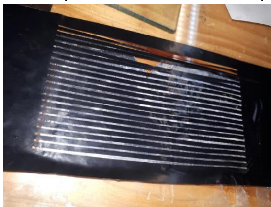
Fig. 9. Pegado de plantilla y pintado de sensores.
