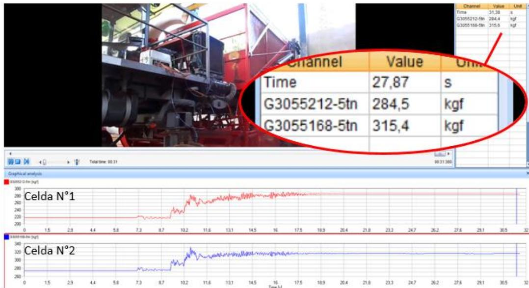
Fig. 7. Verificación de la carga para los 12 discos ubicados dentro del cajón recolector
