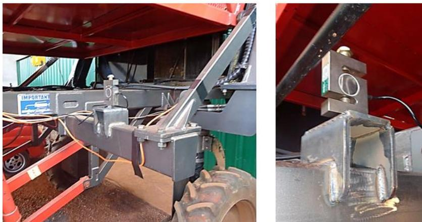
Fig. 5. Montaje de la celda de carga en la estructura del chasis de la máquina
