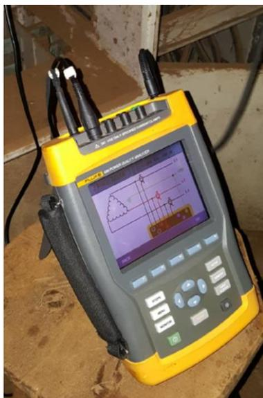
**Fig. 6. Toma de datos de la línea 2 de producción mediante el analizador de redes**
