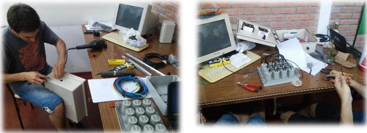
Fig. 3a-3b: Armado y montaje del banco de capacitores
