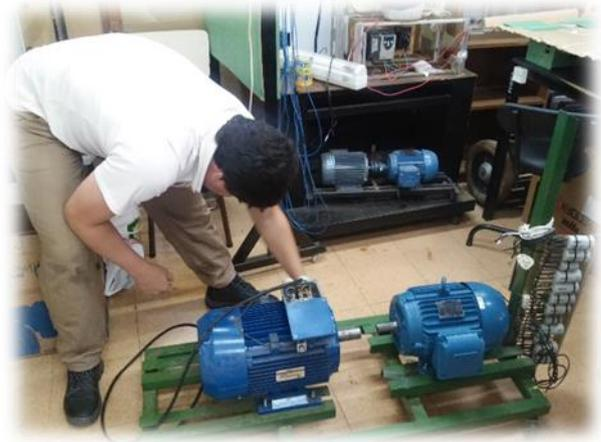
Fig.7a y 7b. Trabajos de alienación del generador.
