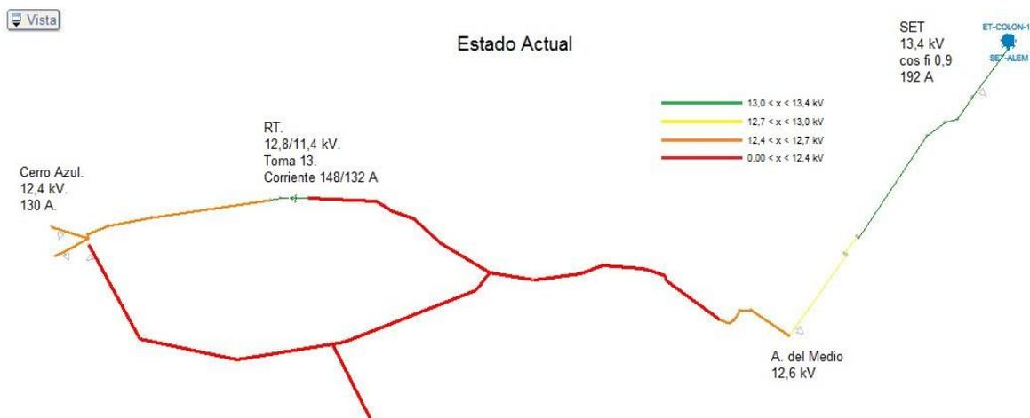
**Fig. 2. Condición de funcionamiento actual. Perfiles de tensión.**
