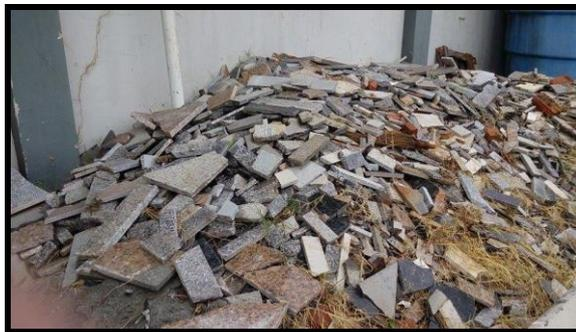
**Figura 1– Rejeitos de granito utilizados como matéria prima do AGRGR.**
