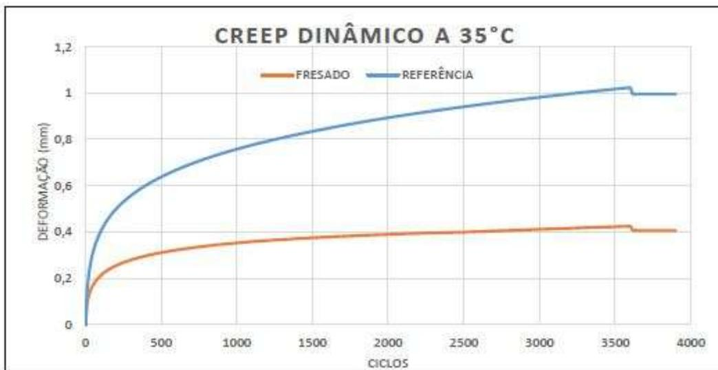
Figura 8: Comparação da média dos resultados das amostras a 35° C.
