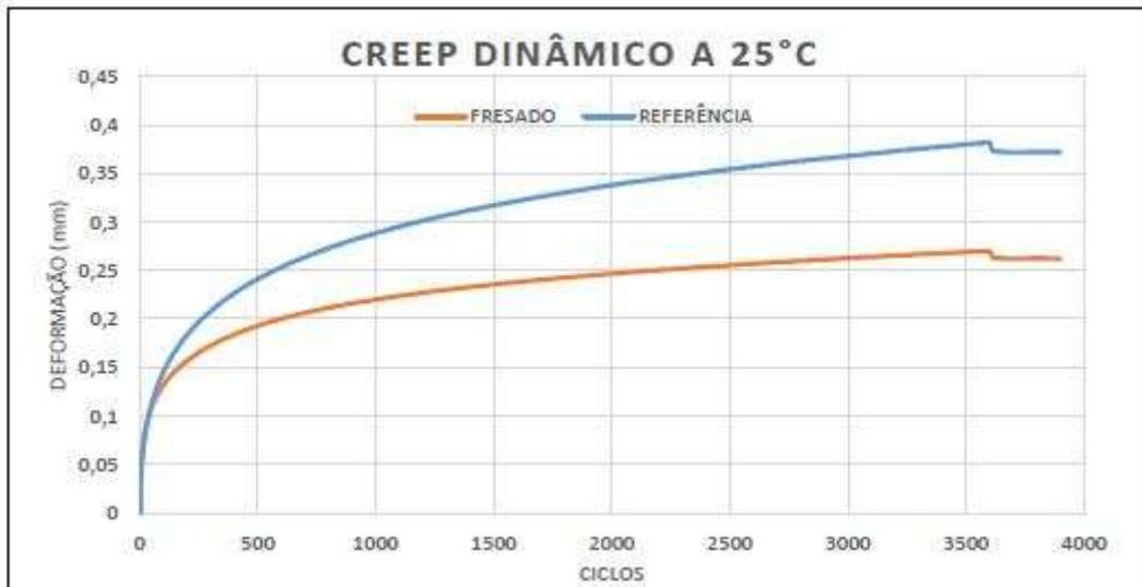
Figura 7: Comparação da média dos resultados das amostras a 25° C.
