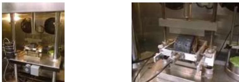
Figura 4: Realização do ensaio de módulo de resiliência na UFSM.
