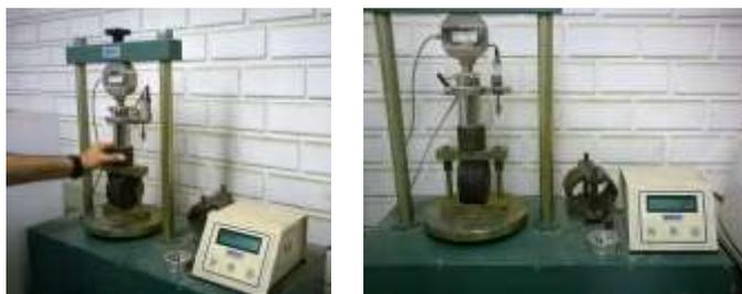
Figura 2: Realização do ensaio de resistência à tração indireta na UFSM.
