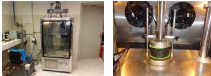
Figura 6: Realização do ensaio de Creep dinâmico na UFSM.
