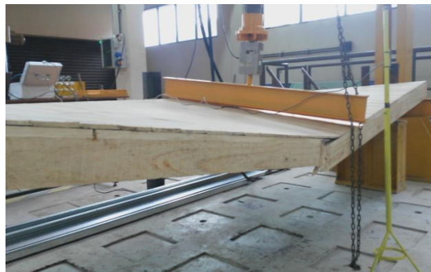
Figura 3. Ensayos de flexión del panel como conjunto estructural.
