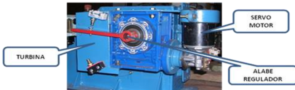
Figura 2: A la derecha de la imagen, es posible observar el servomotor acoplado a la turbina.
