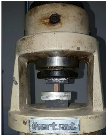
Figura 1. Dispositivo de ensayo a compresión.
