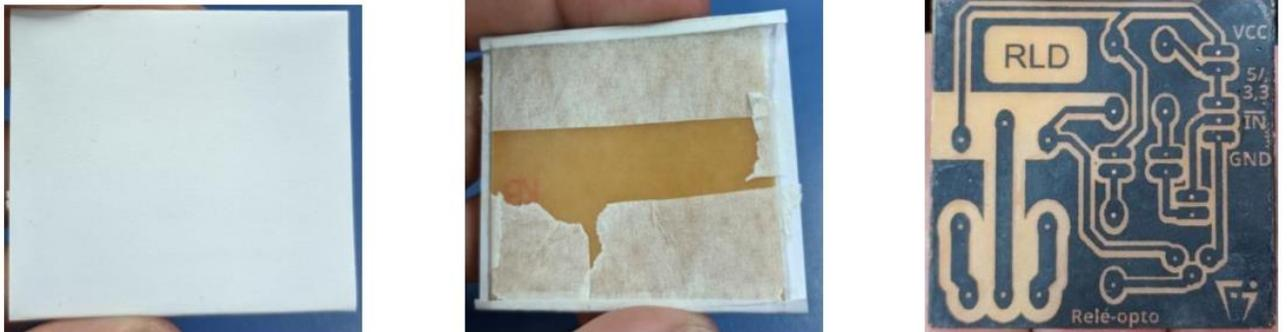
Fig. 5: Proceso de transferencia – Relé GAX1
