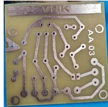
Fig. 2b: Resultado del diseño PCB
