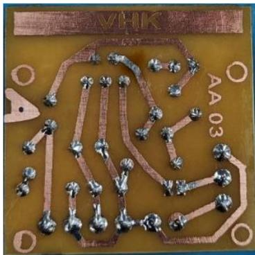
Fig. 3a: Prototipo terminado del lado de cobre
