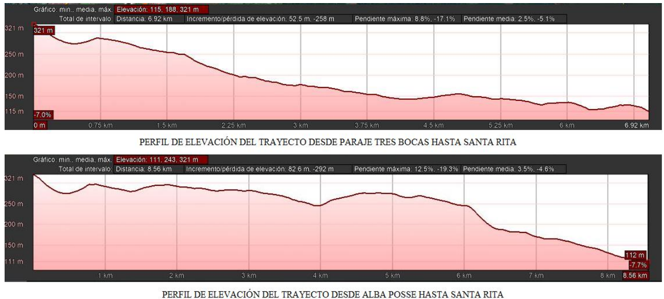
Fig. 3. Perfiles de elevación de los trayectos analizados para la ubicación de la toma de agua.
