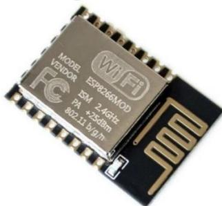
Fig. 4. - Módulo "ESP 12E" empleado en el prototipo.
