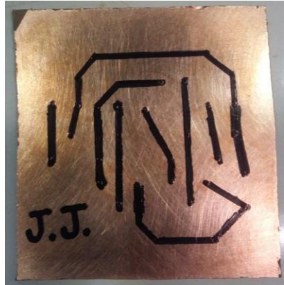
Figura 2: Placa PCB enmascarada para ataque químico
