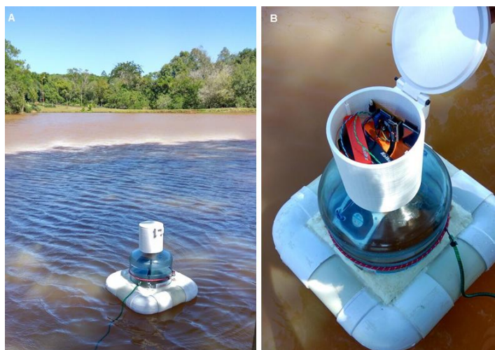
Figura 4. Se ensaya el dispositivo de toma de muestras de gases y análisis de agua en un ecosistema acuático. A) Se muestra una vista del dispositivo sobre el agua. B) Se muestra el interior de contenedor de los materiales electrónicos.
