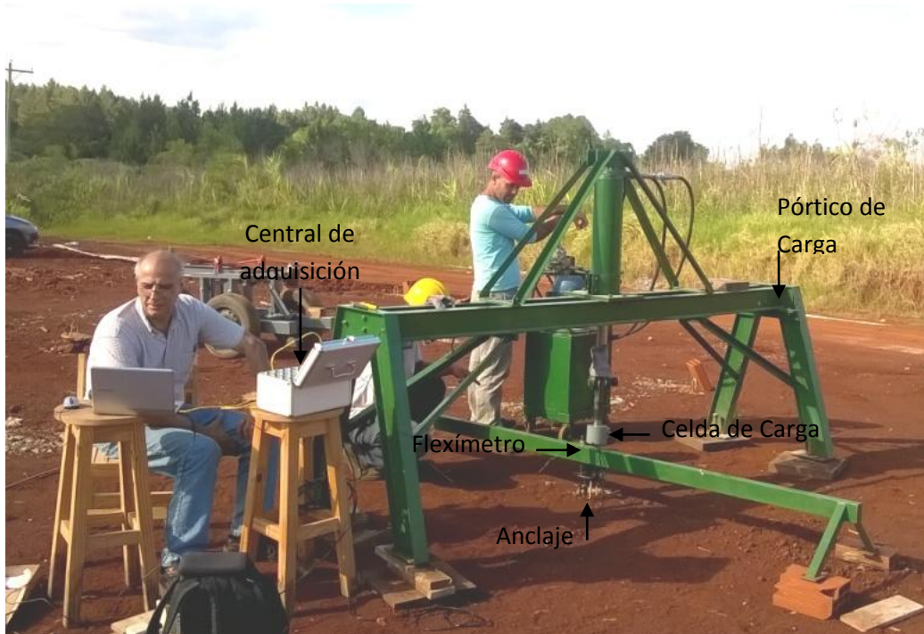
Figura 2: Detalle de equipamiento y ejecución de ensayo de extracción en campo.
