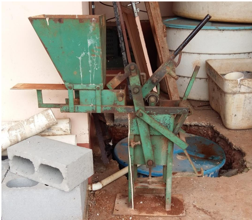
Figura 2. Prensa manual utilizada para confecção dos tijolos
