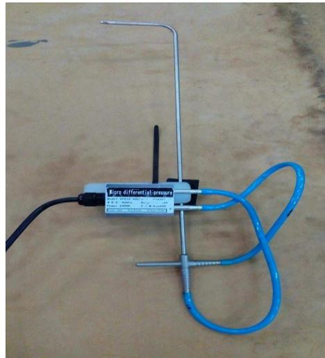
Figura 3: Tubo de Pitot y sensor de presión diferencial
