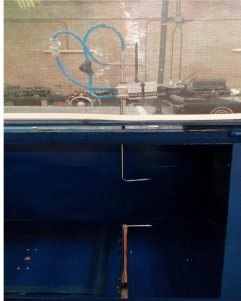
**Figura 4: Disposición tubos de Pitot dentro de la cámara de ensayo**
