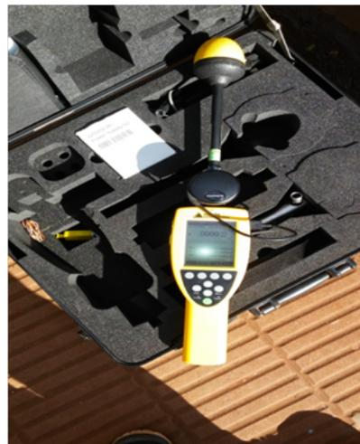
**Figura 2:**Equipo de medición de radiofrecuencias
