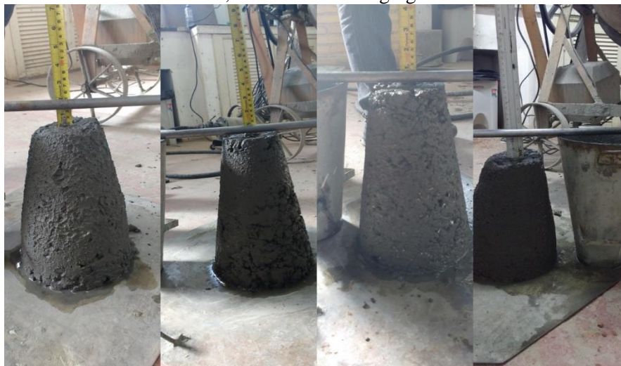
Figura 5- Teste de abatimento realizado no testemunho e nos corpos de prova com a substituição de 30%, 50% e 100% de agregado reciclado.
