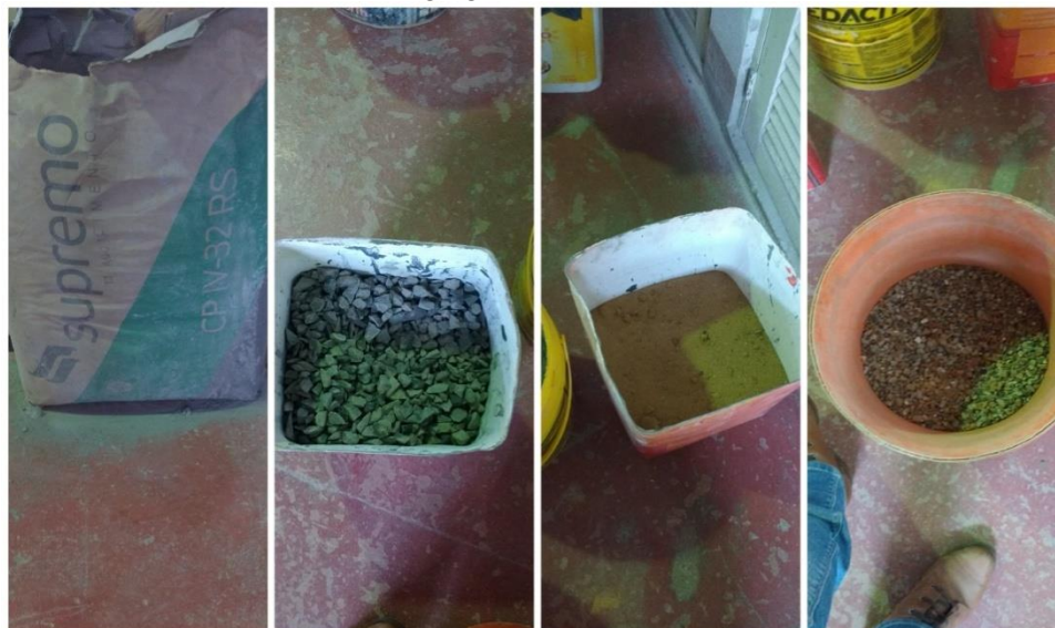
Figura 3- Materiais utilizados para realização do ensaio: cimento Supremo CP IV- 32 RS; brita; areia; agregado reciclado.
