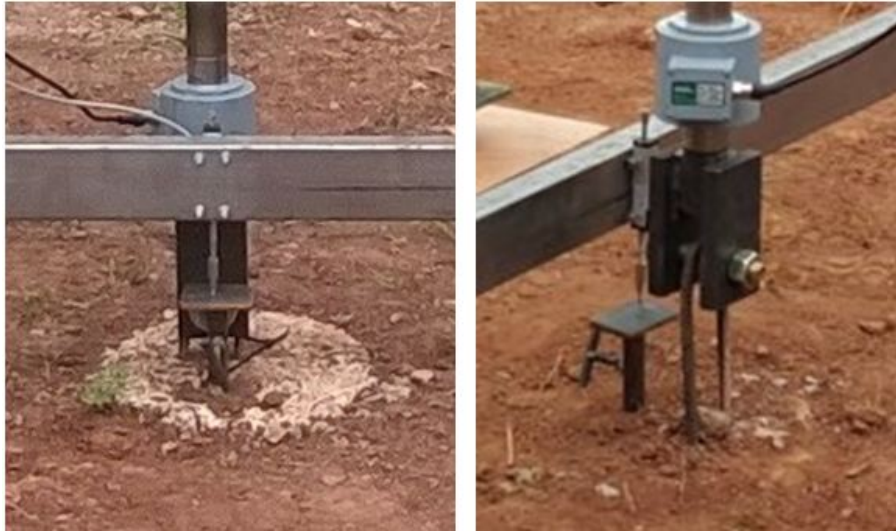
Figura 7: “Disposición de comparador y dispositivo de ajuste”
