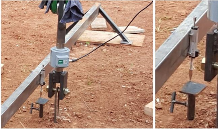
Figura 3: “Montaje de celda de carga y flexímetro en campo”
