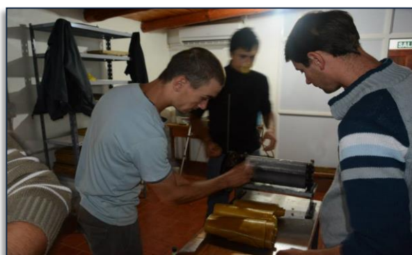
Maquina estampadora de cera de rodillos del tipo Root-Washburn utilizada en PROCAYPA - Capioví – Provincia de Misiones – Fuente: Propia
