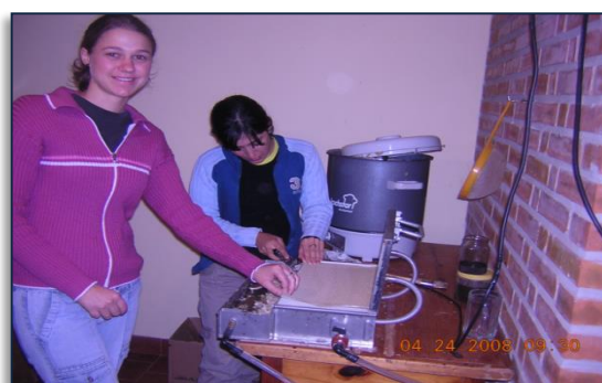
Maquina estampadora de cera de prensa tipo Given utilizada en PROCAYPA - Capioví – Provincia de Misiones – Fuente: Propia
