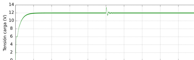
Ilustración : respuesta ante variación de la carga del 100 % al 50 % con componentes reales
