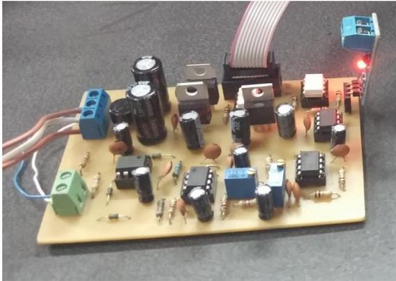
**Figura 4: Placa de sensado.**
