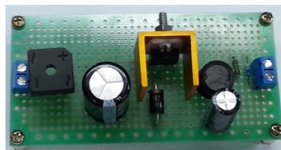
Figura 6: Foto de la fuente de alimentación en placa experimental.
