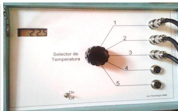
Imágen 2 : Equipo de medición con sensores 1,2 y 3 conectados al LM35
