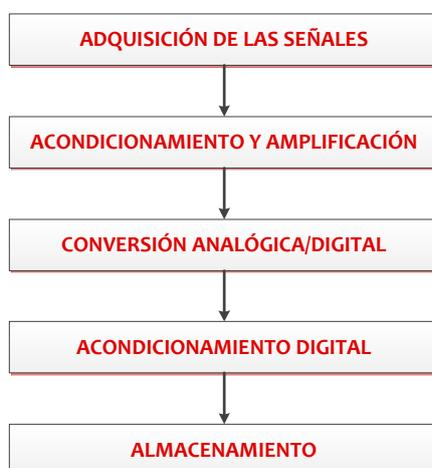
*Figura 1: Diagrama de bloques del holter cardiaco.*
