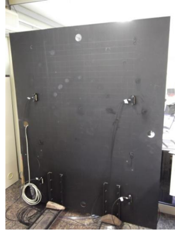
Figura 2. Esquema de montaje de sensores en la chapa.
