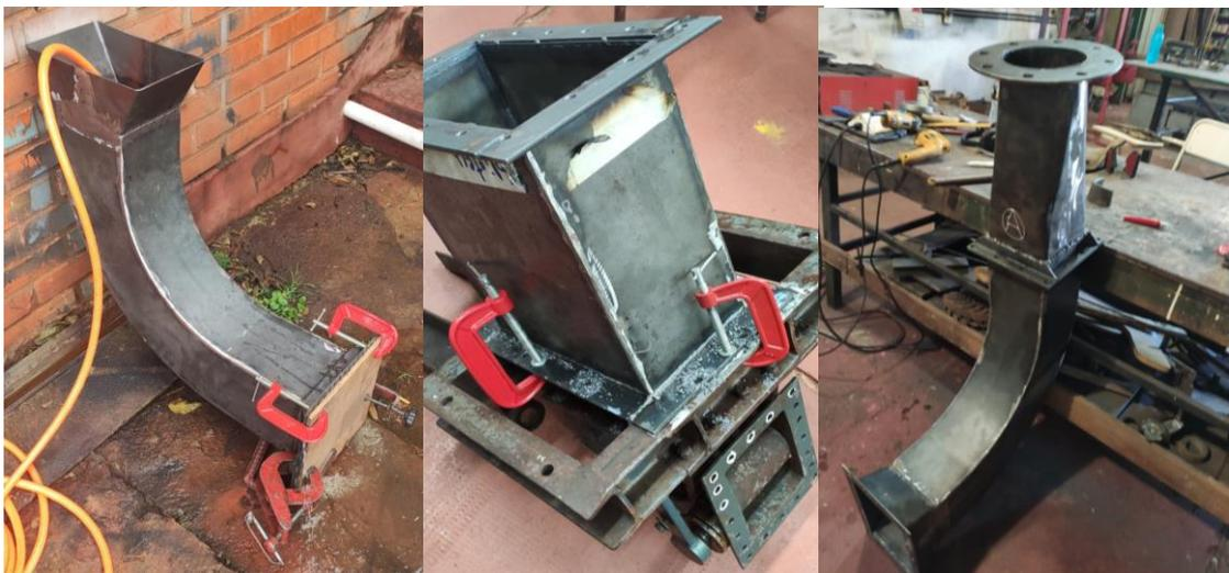
**Figura 9** - Fabricación de la conducción y pruebas hidráulicas individuales y de montaje iniciales.
