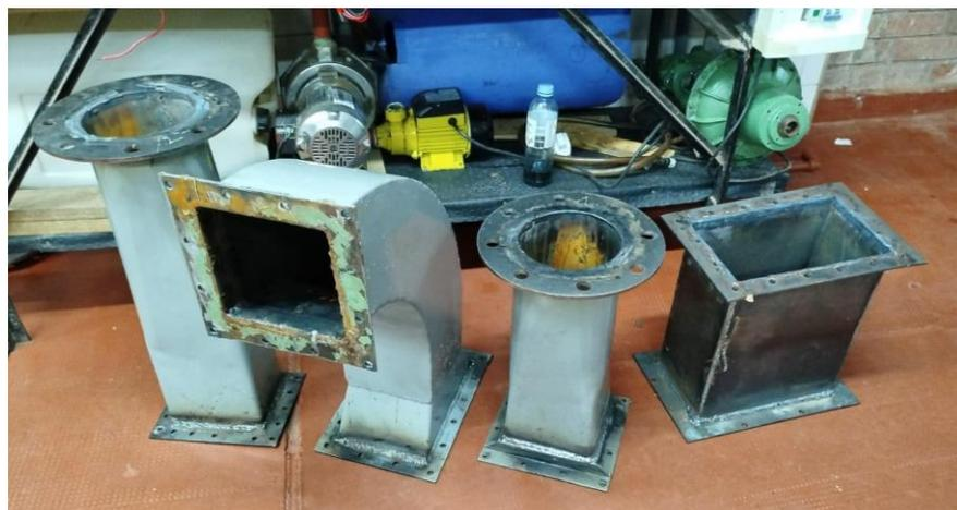
De la figura 8 a la 10 se puede ver el proceso de elaboración de la conducción y también pruebas que se le fueron haciendo a las mismas para asegurar una soldadura resistente y hermética y a su vez evitar problemas de montaje en esta etapa se puso a prueba el criterio de diseño de todo el proyecto.
