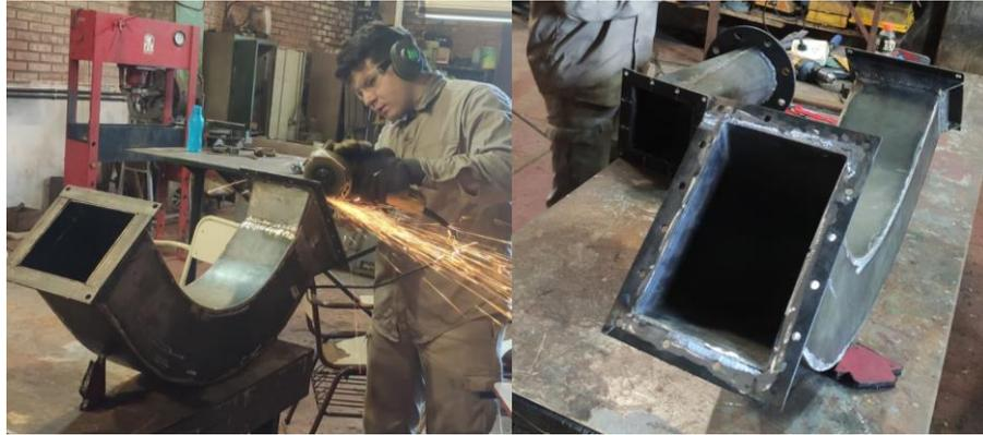
**Figura 8** - Fabricación de la conducción
