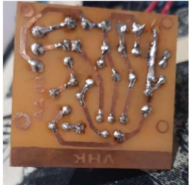
Fig. 2 b: PCB lado cobre o soldadura
